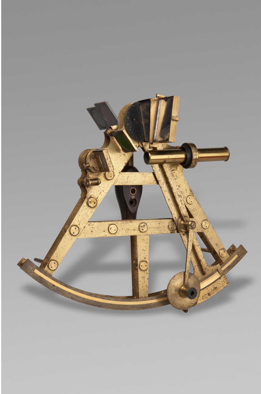
Der Gauß'sche Vizeheliotrop - London 1810, modifiziert 1821 von C.F. Gauß, Sammlung historischer physikalischer Apparate „Physikalisches Cabinet“, Göttingen. Foto: Stephan Eckardt.
